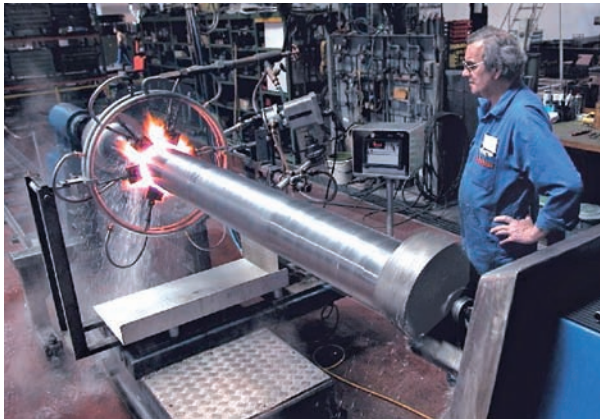
Bild 21: Flammhärten einer Kolbenstange für einen Schiffdieselmotor
