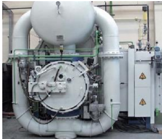
Bild 47: Vakuumofen zum Einsatzhärten (Fa. Aichelin)
