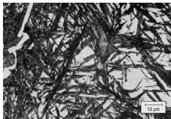
Bild 27: Überkohlte Randschicht mit Restaustenit und Carbiden
