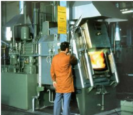
Bild 45: Prozessgas-Kammerofen zum Einsatzhärten (Fa. Ipsen)
