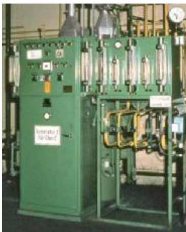
Bild 46: Endogasgenerator (Fa. Ipsen)
