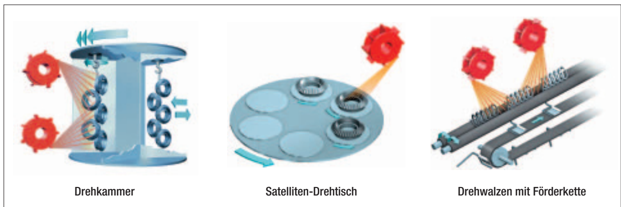
Abb. 18: Beispiele für Sonderbauformen von Schleuderradstrahlanlagen zum Kugelstrahlen
