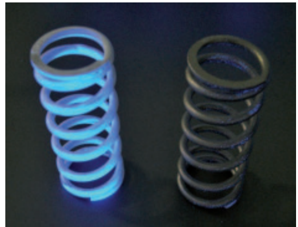
Abb. 28: Fotografische Vergleichsmuster zur Beurteilung des Deckungsgrades
