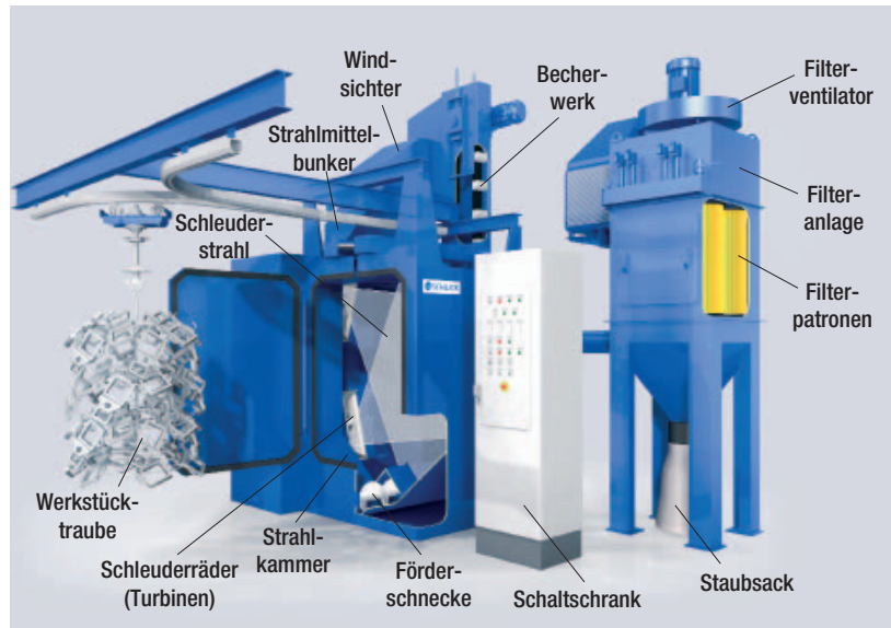
Abb. 19: Aufbau einer typischen Schleuderradstrahlanlage
