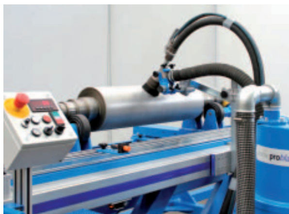
Abb. 13: Saugkopfstrahlen einer Stahlwalze zur Aufrauung vor dem Beschichten
