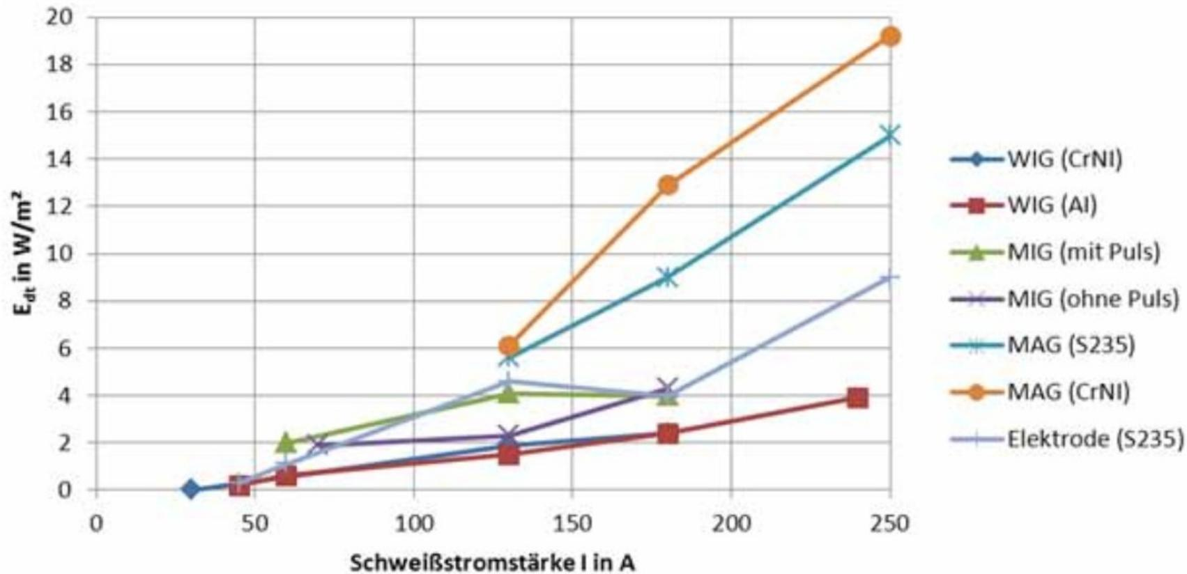
Abb. Effektive Bestrahlungsstärke in 60 cm Abstand vom Lichtbogen bei verschiedenen Schweißverfahren (Radiometer Messwerte)
